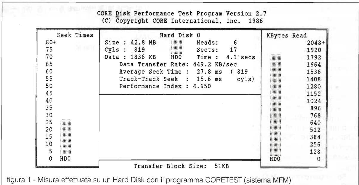
figura 1 - Misura effettuata su un Hard Disk con il programma CORETEST (sistema MFM)
