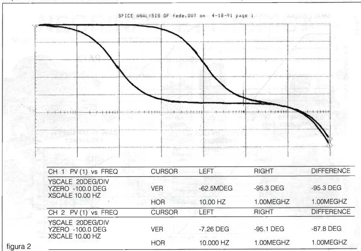
Il punto a -3 dB della curva di risposta (in pratica dove è situato il primo polo) si ottiene dividendo il GBW per il guadagno, quindi in questo caso  $7.5 \text{ MHz} / 1000 = 7.5 \text{ kHz}$ ; questo punto equivale in fase ad una rotazione di -45 gradi.
