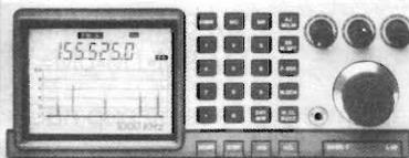
Scanner con analizzatore CRT incorporato.
