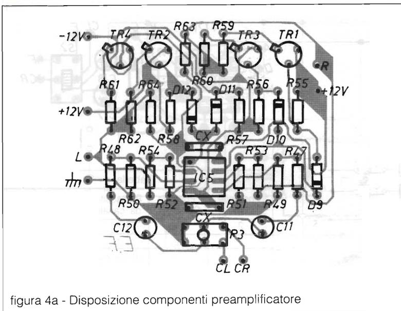
figura 4a - Disposizione componenti preamplificatore
