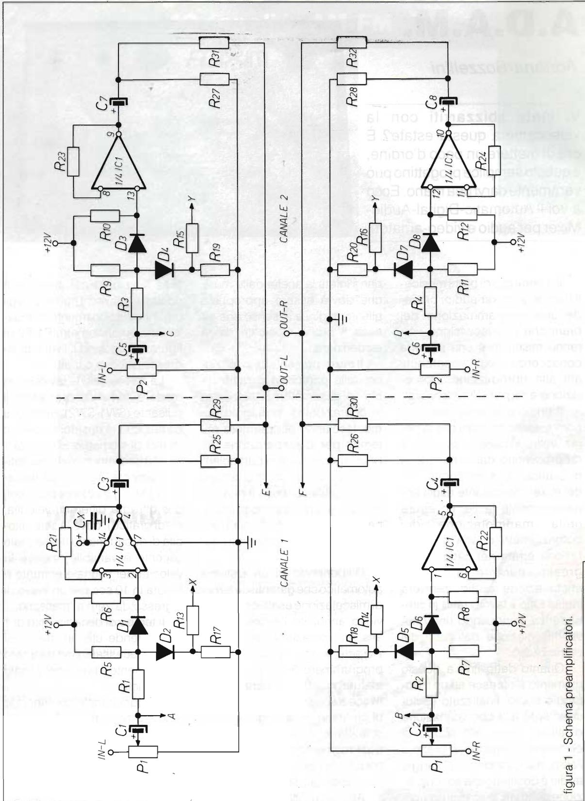
figura 1 - Schema preamplificatori.
