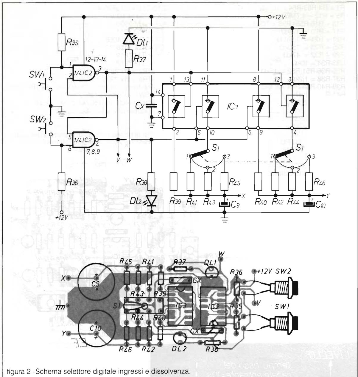
figura 2 - Schema selettore digitale ingressi e dissolvenza.
