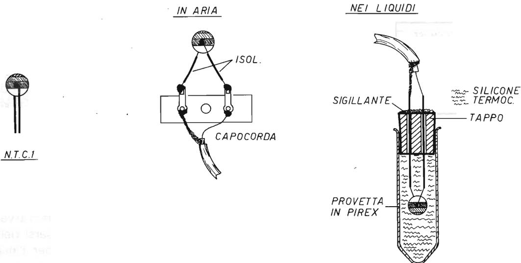
figura 4 - Realizzazione e isolamento del sensore di temperatura.
