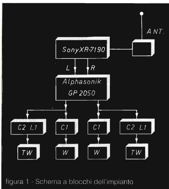
figura 1 - Schema a blocchi dell'impianto
