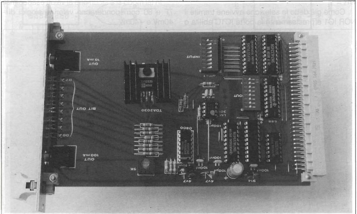
un buon esempio di come si possa controllare un motorino tramite una scheda D/A e una scheda di input a interruttori (vedi 4ª parte).
