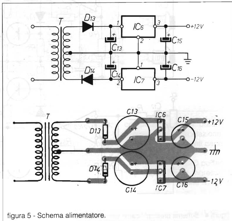
figura 5 - Schema alimentatore.
